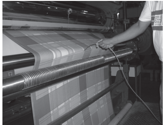
Figura 5. Operador da calandra realiza a limpeza da máquina com jato de ar comprimido para eliminar sujeiras do tecido e cilindros.
