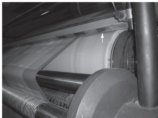
Figura 2. Detalhe do cilindro inferior. Barra de proteção contra entrada de objetos estranhos. Notar o ponto da entrada da mão do reclamante (seta). Na parada da máquina o cilindro inferior abaixa e aumenta o vão entre os cilindros para permitir a recolocação do tecido, porém ainda mantém o giro agora em baixa velocidade. Na partida o cilindro inferior volta à posição normal, fechando o vão entre os cilindros. Nesses dois momentos a colocação da mão do trabalhador em área de risco (próximo aos cilindros) pode gerar o apresamento da mão e o acidente de trabalho.
