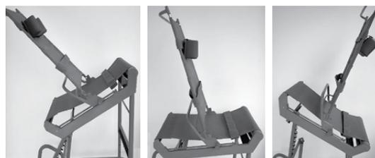
Figura 6. Característica do protótipo em relação a flexibilidade e compatibilidade: sequência da variação de inclinação.
